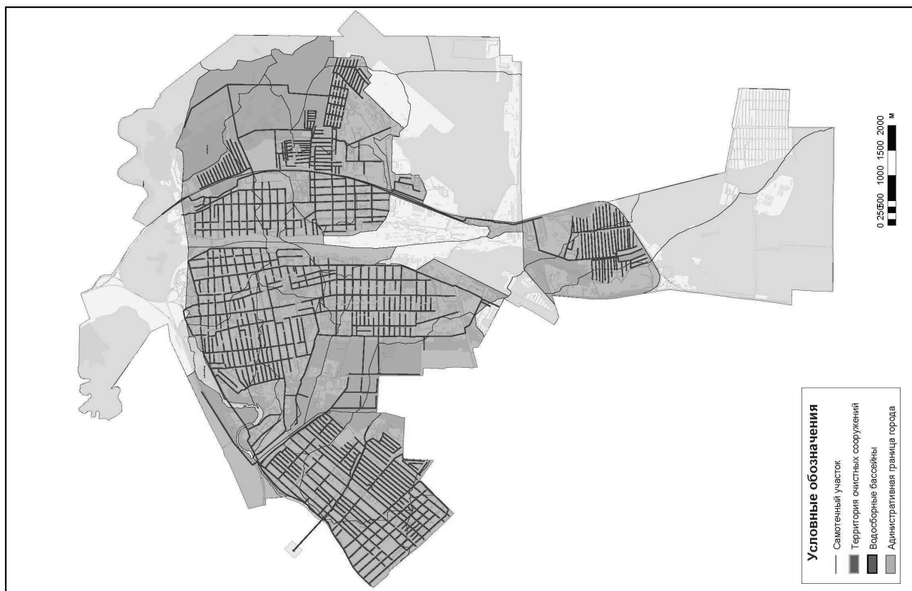
Рисунок 23 - Водосборные площади формирования поверхностного стока
