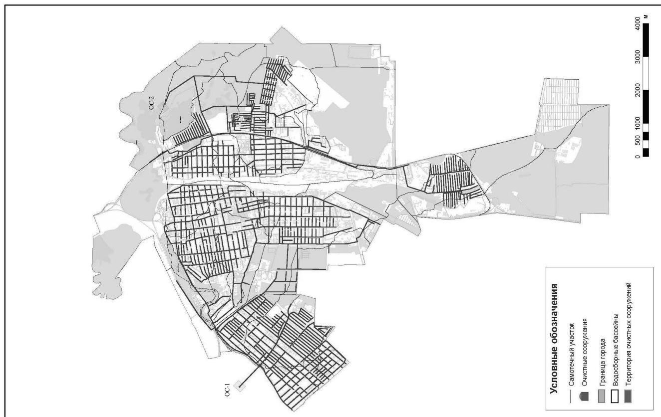
Рисунок 29 – Первый вариант маршрутов прохождения трубопроводов
