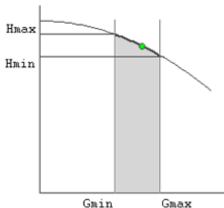
Рисунок 33. Напорно-расходная характеристика насоса
